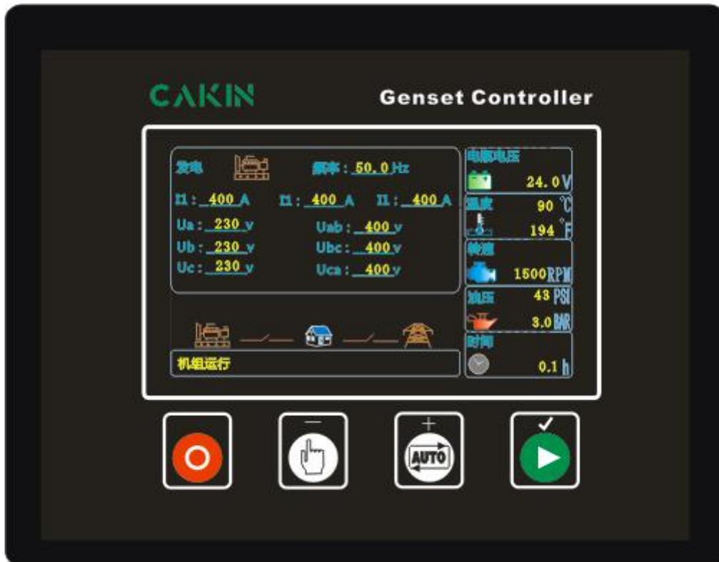
本说明资料为使用 CA3120 系列控制器时提供快速操作指引，详细请参阅标准使用说明。CA3120 控制器用于单台发电机组的自动化操作，可自动开关机、数据测量、报警保护、4.3 寸 LCD 彩色图形显示、中/英等言显示，所有参数可通过按钮调试。
