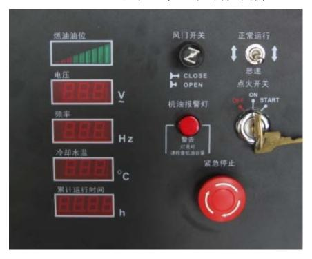
QYCB-1型汽油发电机组控制板使用于手动控制机组,可安装机组箱体里。 配启动开关、急停开关、怠速运行开关、风门开关、机油报警开关状态指示灯。 可通过单片机检测,LED显示燃油油位,发电机电压、频率,冷却水温、机组运 行时间。
